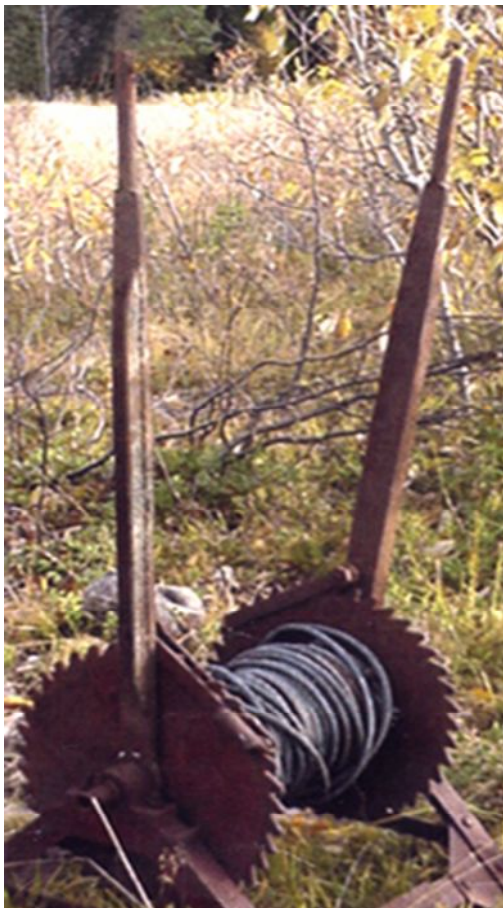
Spel till speleka. Spelet fungerade så att man växelvis höll mot i den ena spaken och drog i den andra. Låset på respektive kugghjul var till för att säkra spelet. Foto Eskil Tåg.2003
